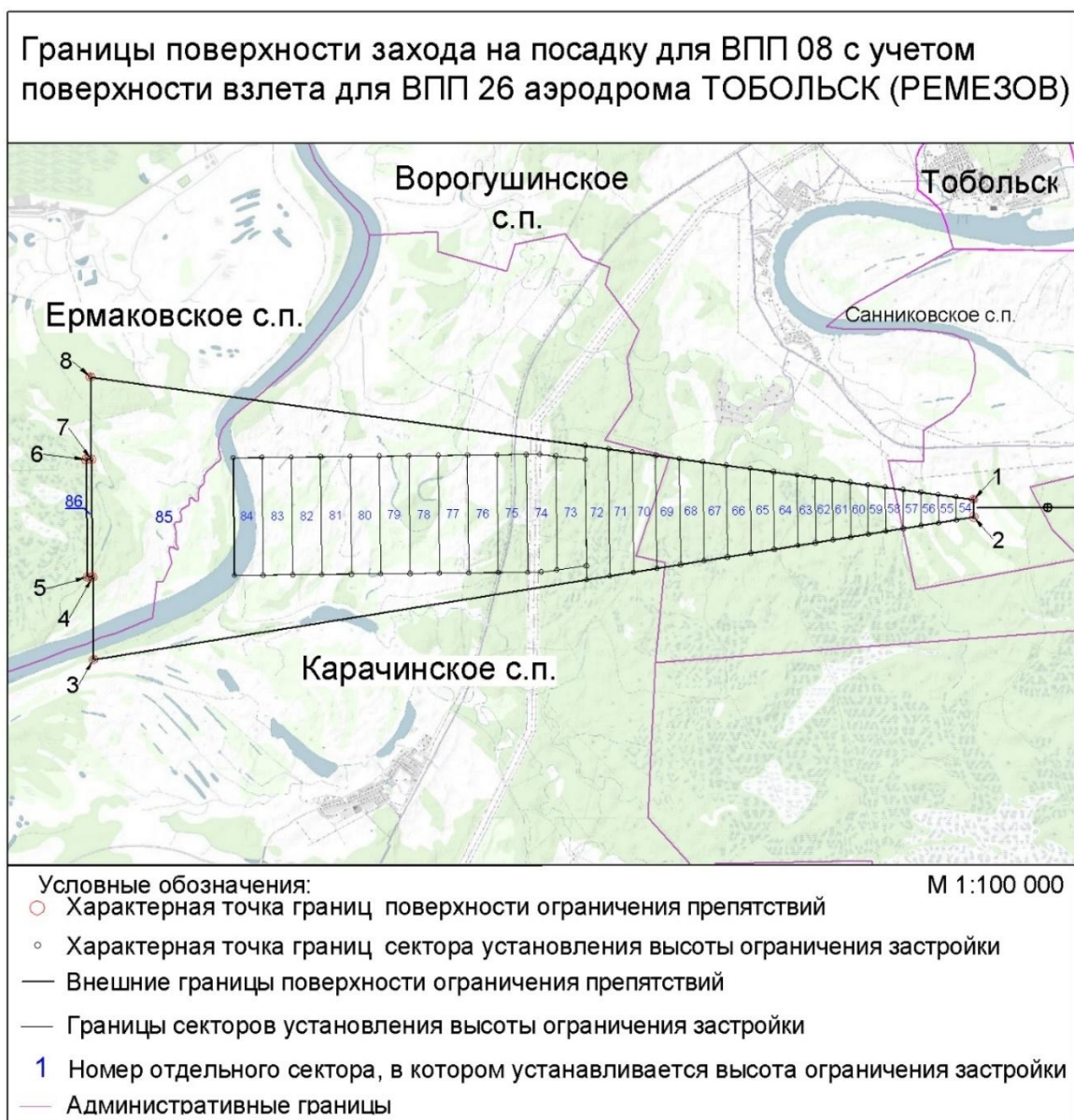
Рисунок 4.3. Схема местоположения границ поверхности захода на посадку для ВПП 08 с учетом поверхности взлета ВПП 26
