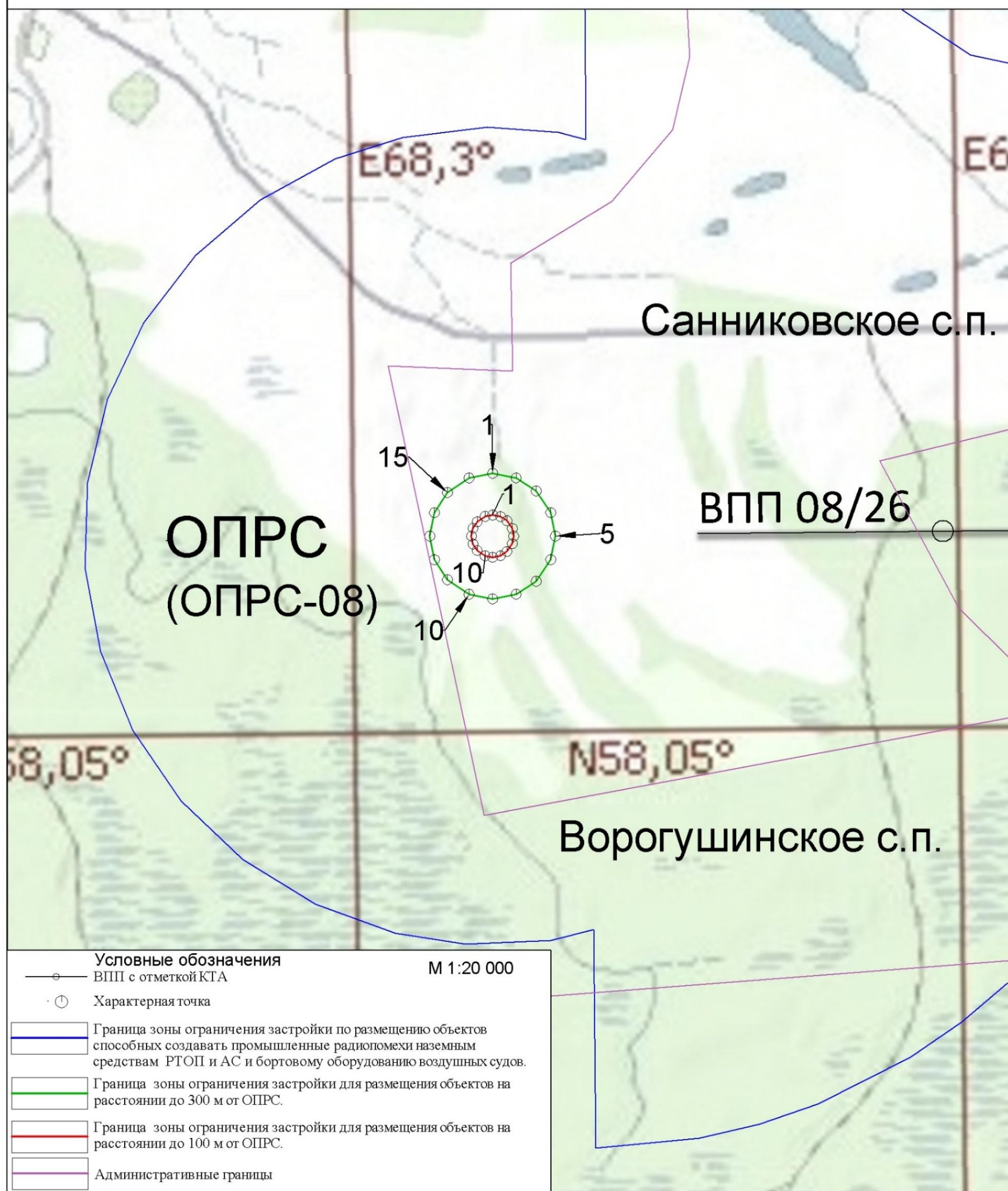
Рисунок 5.3. Схема местоположения границ зоны ограничения застройки для размещения объектов на расстоянии до 100 м и 300 м от ОПРС
