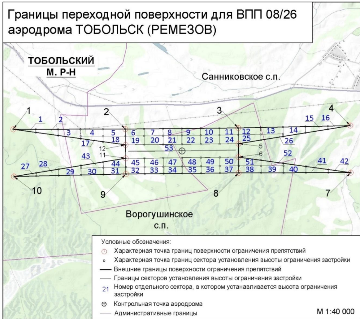
Рисунок 4.2. Схема местоположения границ переходной поверхности для ВПП 08/26
